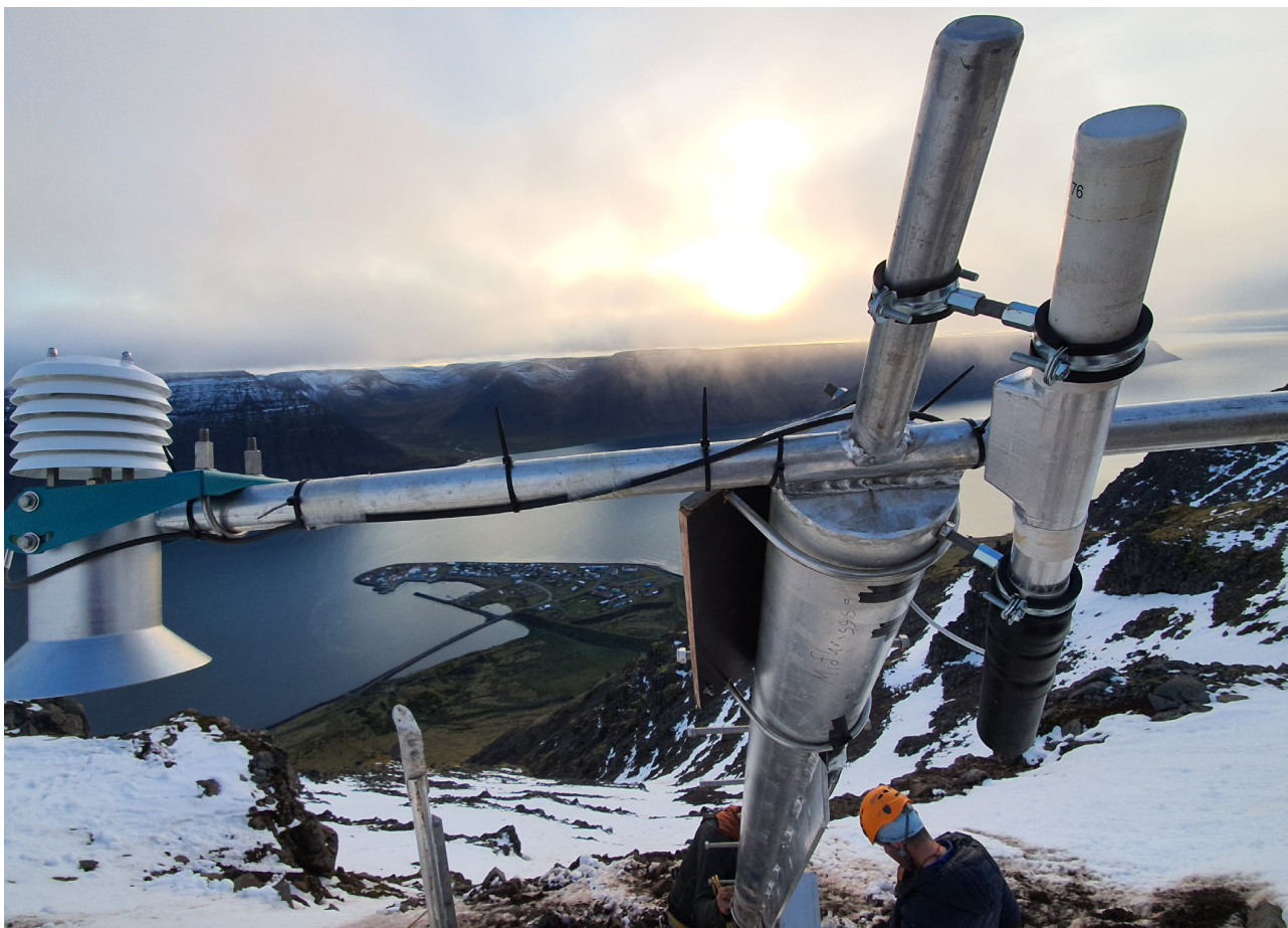
Til vinstri á mastrinu má sjá bergmálmælinn. Hægra megin er rafeindabúnaður og leysimælir sem fylgir SM4 mælinum en sjálfur mælirinn er kapall sem festur er við mastríð. Bergmálmælur hafa lengi verið notaðir hér á landi til þess að mæla snjódypt. Þeir senda frá sér hljóð og mæla endurkastið eða bergmálið og þannig snjódyptina. Það er kostur að hafa fleiri en eina gerð af snjódyptarmælum þar sem mismunandi mælar henta við mismunandi aðstæður. (Ljósmynd: Harpa Grímsdóttir).
